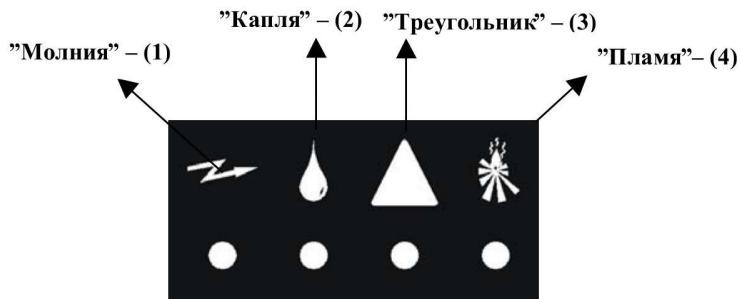
При включении осушителя посредством функционального выключателя ON/OFF светоиндикаторы на дисплее будут какое-то время поочередно высвечиваться зеленым цветом до тех пор, пока осушитель не выйдет на устойчивый режим, что соответствующим образом отобразится на дисплее.
